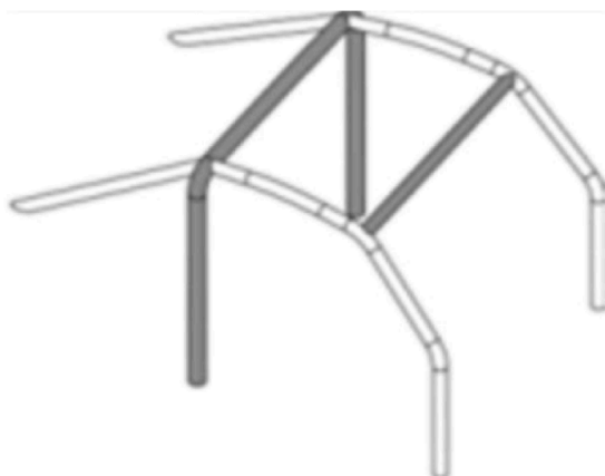
Figur 3. Grundkonstruktion av skyddsbur typ 3.
